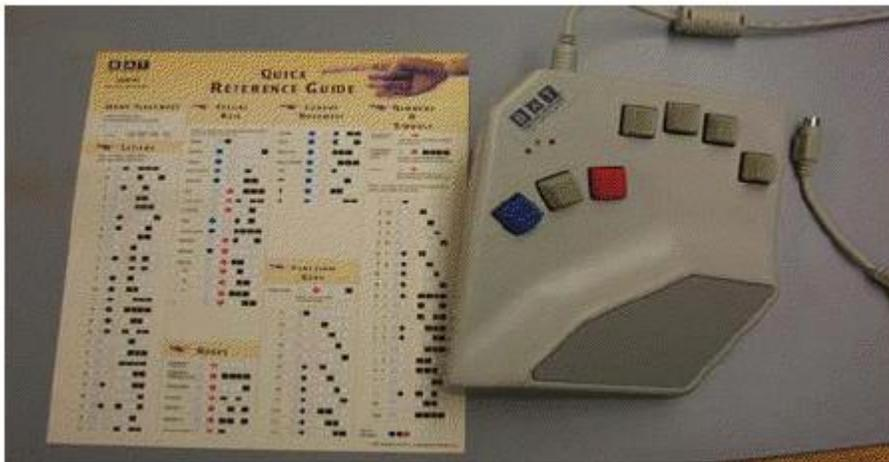
**Un clavier à accord à 7 touches, 3 pour le pouce, plus mobile et plus adapté à l'accord avec les autres.**
