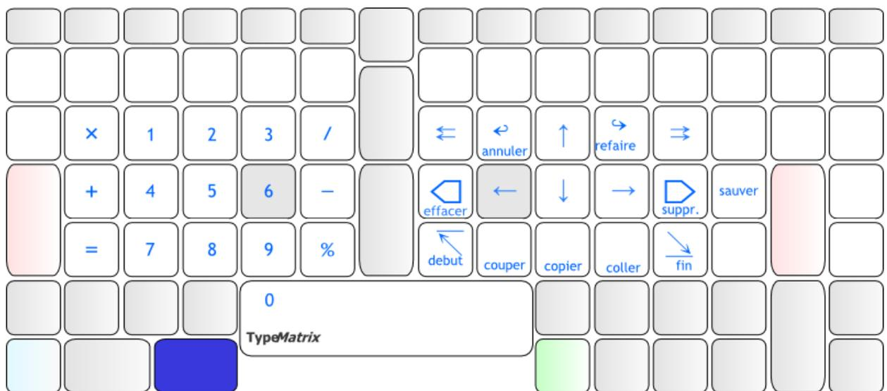
À gauche les chiffres, sous les trois doigts de repos. Le 0 sur la barre espace, car c'est le plus fréquent des chiffres. À droite, la navigation dans un texte. On retrouve les directions sous les doigts les plus forts, entourées de l'avance rapide (ctrl+coté) en haut, début et fin de ligne sur les côtés, copier-coller en bas, etc.
